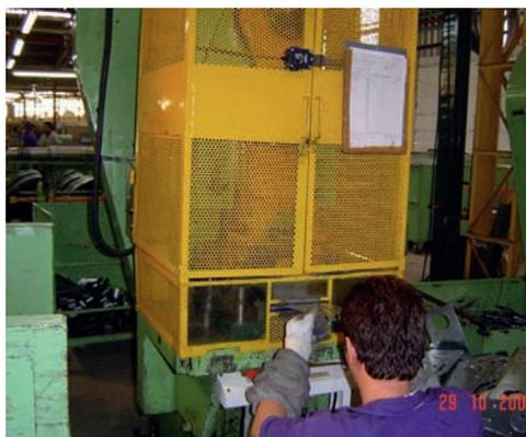
Figura 55 – Fechamentos das zonas de prensagens com proteções móveis e com bloqueio.
