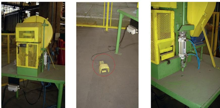
Figura 49 – PMEEC com acionamento através de pedal elétrico.
