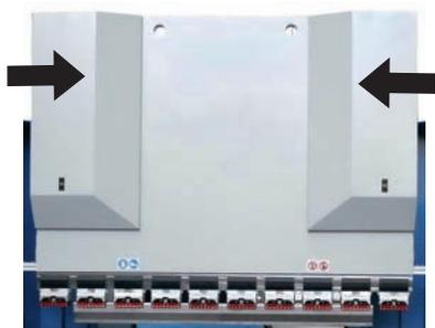
Figura 100 – Carenagem envolvendo os cilindros.
