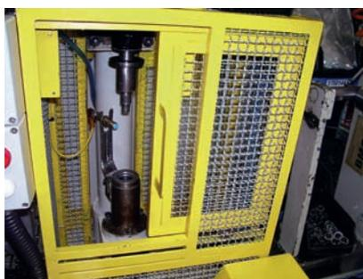
*Figura 6 - Monitoramento por chave de segurança magnética ou chave de segurança por radiofrequência ou chave de segurança óptica ou duas chaves de segurança mecânicas.*
