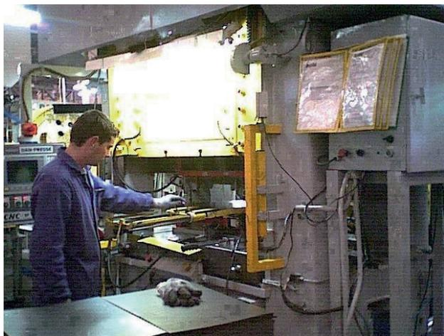
*Figura 27 – Conjugação de cortina de luz e gaveta em prensa hidráulica.*
