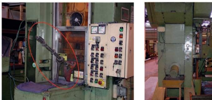
*Figura 153 – Alimentação através de dispositivo por gravidade.*
