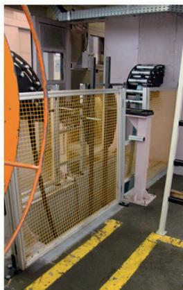
*Figura 156 – Desbobinadeira e chapa protegida em todo o perímetro até a entrada da cabine.*
