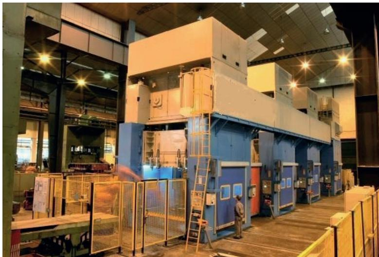
*Figura 66 – Conjunto de prensas mecânicas excêntricas rápidas com acionamento automático e alimentação robótica com proteções fixas conjugadas com proteção móvel intertravada, inclusive proteção de perímetro (proteção fixa distante conjugada com proteção móvel intertravada e cortina de luz para a área do robô).*
