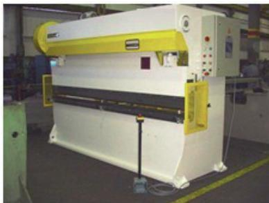
*Figura 98 – Dobradeira descendente mecânica com freio-fricção pneumática.*
