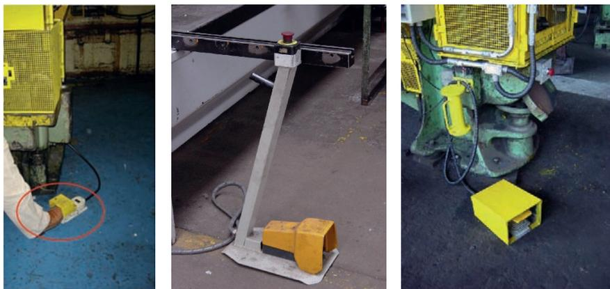
Figura 48 – Caixa de proteção nos pedais de acionamento.
