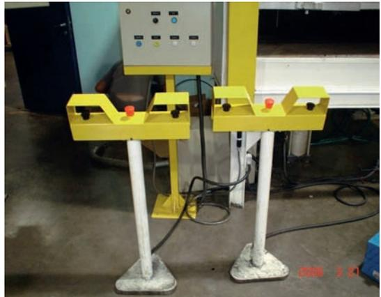
Figura 18 – Comando bimanual com botão de emergência.
