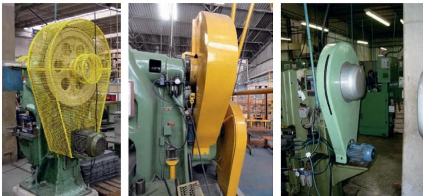
Figura 52 – Transmissões de forças de prensas protegidas.
