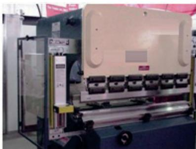
Figura 110 – Dobradeira ascendente hidráulica.
