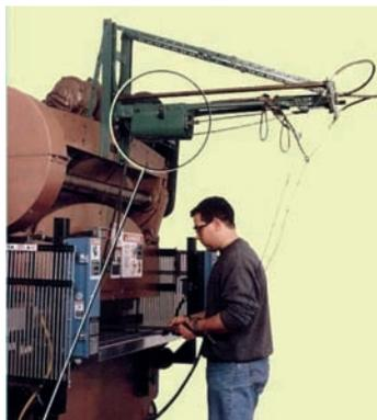
Figura 59 – Afasta-mãos instalado em dobradeira.
