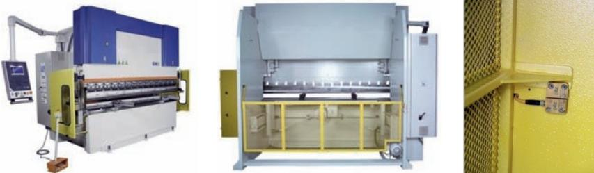
Figura 115 – Proteções laterais e traseira móvel com intertravamento elétrico.
