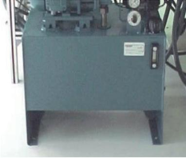
*Figura 83 – Reservatório de fluido hidráulico.*
