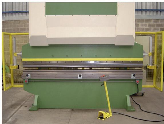
Figura 177 – Dobradeira mecânica transformada em dobradeira hidráulica.
