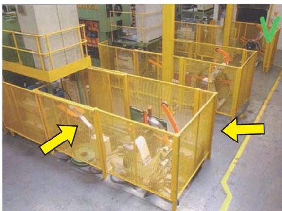
*Figura 157 – Área de desbobinadeira protegida.*
