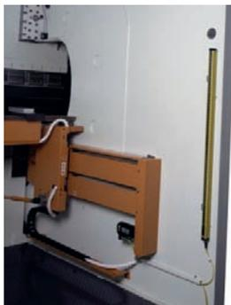
Figura 116 – Proteção traseira com cortina de luz.
