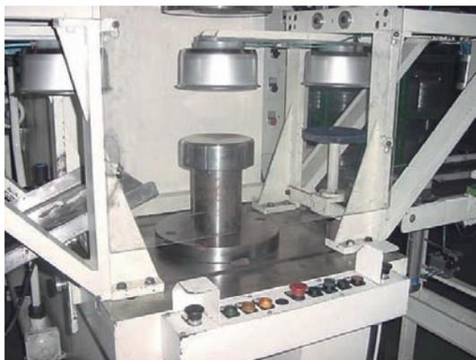
*Figura 155 – Alimentador contínuo com braço magnético e proteção fixa de policarbonato na zona de prensagem.*
