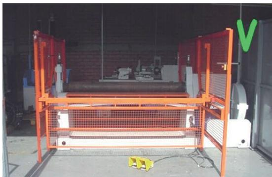
*Figura 136 – Calandra com proteção do tipo mesa deslizante e empurrador.*
