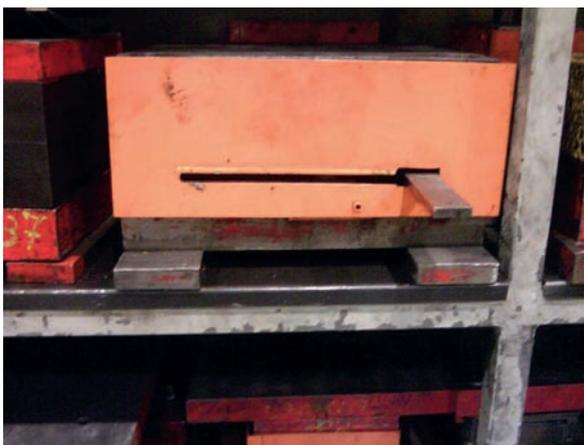
*Figuras 13 – Ferramenta fechada. As dimensões e a geometria das aberturas deverão obedecer à NBR 13852.*
