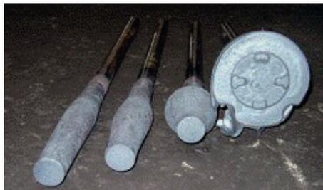
*Figura 141 – Recalcadora tipo up-setter e seu produto forjado em 4 etapas.*
