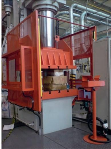
*Figura 78 – PH: Prensa hidráulica.*
