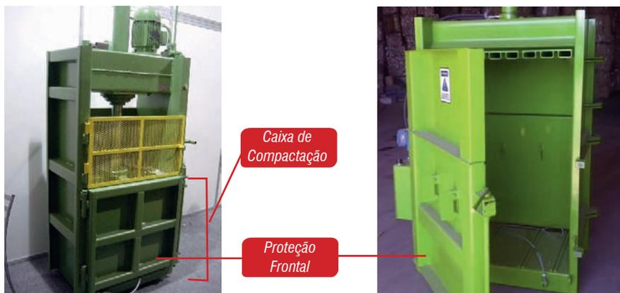
Figura 143 – Proteções da máquina.
