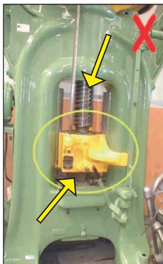
Figura 76 – PMFAF com zona de prensagem desprotegida.
