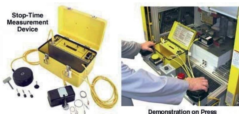
Figura 19 – Aparelho de medição de tempo de parada de máquinas.
