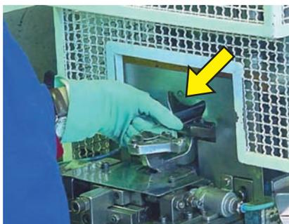
*Figura 148 – Alimentação manual em zona de prensagem protegida.*
