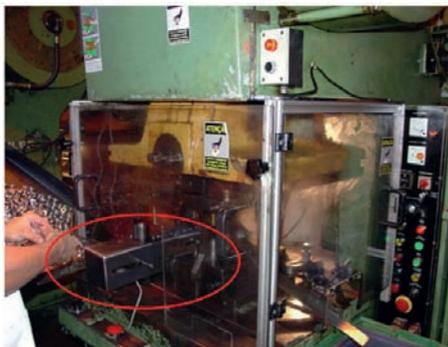
*Figura 149 – Alimentação através de dispositivo pneumático.*
