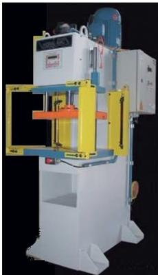
Figura 25 – Cortina de luz com espelhos, para proteção frontal e lateral.
