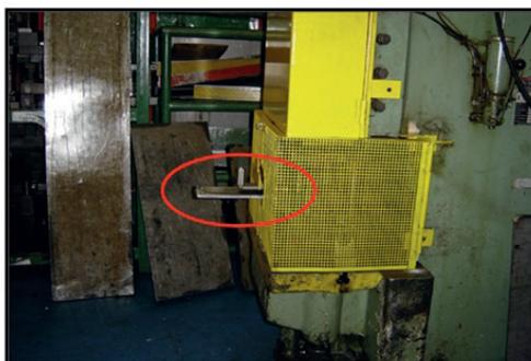
*Figura 150 – Dispositivo tipo gaveta com movimentação manual, com a área de risco totalmente protegida.*
