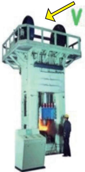
Figura 77 – PMFAF com proteção nos volantes.
