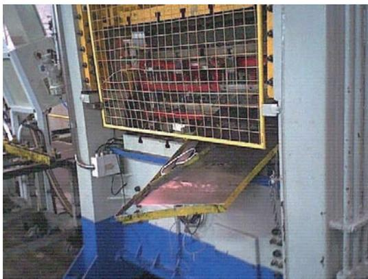
*Figura 154 – Zona de descarregamento de peças ou retalhos (parte traseira da prensa).*
