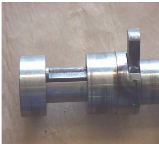
Figura 42 – Conjunto montado dos componentes responsáveis pelo acoplamento.
