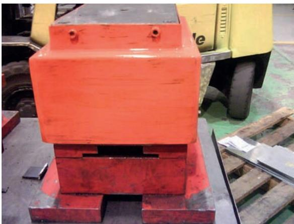
*Figuras 12 – Ferramenta fechada. As dimensões e a geometria das aberturas deverão obedecer à NBR 13852.*
