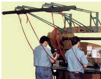
Figura 58 – Afasta-mãos instalado em dobradeira.
