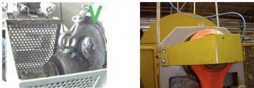
Figura 53 – Proteção da ponta dos eixos.
