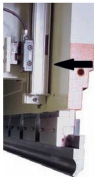
Figura 105 – Monitoramento da posição do prensador.
