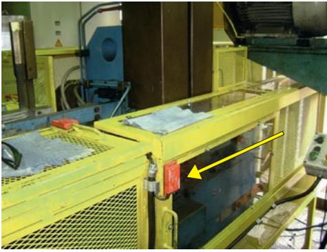
*Figura 10 – Enclausuramento da zona de prensagem por proteções móveis intertravadas – fechada.*
