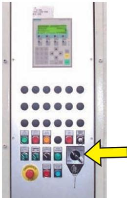
*Figura 161 – Chave seletora de posições tipo yale.*
