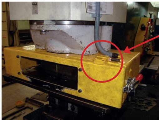
Figura 7 – Enclausuramento da zona de prensagem, frestas para passagem da peça.
